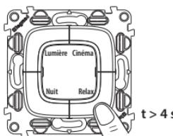
Для программирования нажимать на клавишу в течение более четырех секунд.
