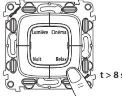
Om een scenario te wissen, gedurende minstens acht seconden drukken op de toets m.b.t. het te verwijderen scenario.
