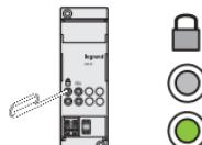
Нажать на кнопку подключения программирования модуля сценариев
