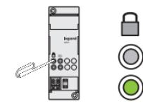
Sur le Module Scénarios, appuyer sur le bouton d'activation de la programmation.
