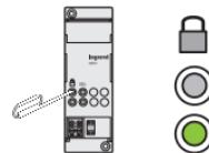
In de Module Scenario's drukken op de drukknop van opstarten voor de programmering.
