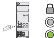
Sur le Module Scénarios, appuyer sur le bouton d'activation de la programmation.
