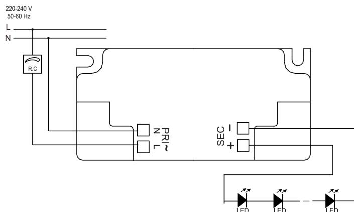
Die maximale Länge der Ausgangsleitung von 2 m darf nicht überschritten werden.
