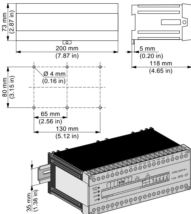
Pour garder la possibilité de démonter l'appareil sans débrancher les connexions, il est conseillé de prévoir 1 à 2 cm de longueur de câble supplémentaire pour pouvoir retirer les borniers.
