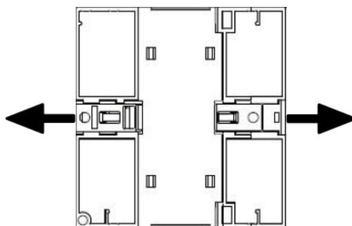
7.5-1 Montaż na ścianie: sposób wysunięcia elementów montażowych
