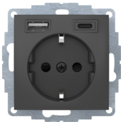
B.x Gniazdo SCHUKO z gn. ładowania USB A+C 2.4/3.0 A; samozaciski; antracyt mat
