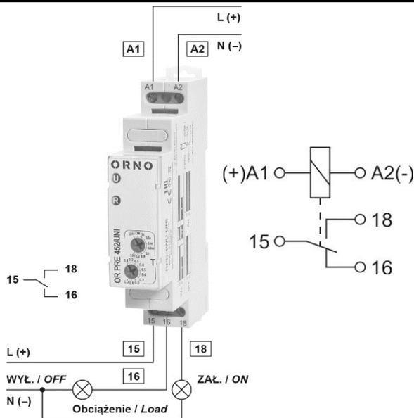
**Połączenia:** maks. przekrój przewodów: 1 x 2,5 mm<sup>2</sup> (1 x 14 AWG), długość odizolowania przewodów: 6,5 mm, maks. moment dokręcenia zacisku: 0,5 Nm.
