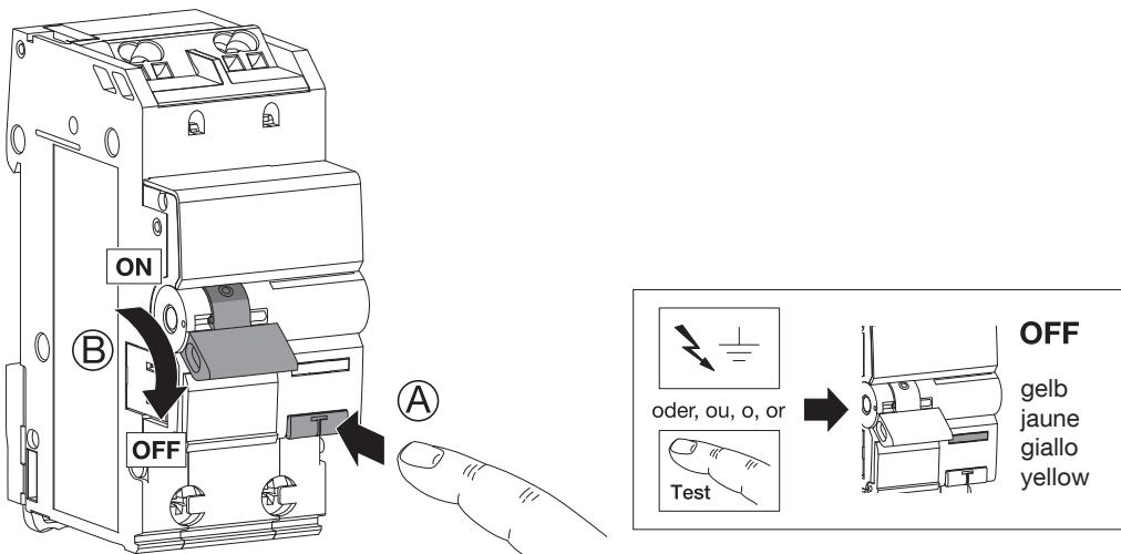
Kontaktstellungsanzeige / Indicateur de position de contacts / Posizione dei contatti visualizzata / Contact position indicator
