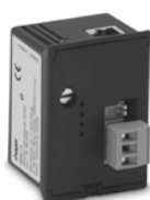
SM214: komunikacja ethernet + RS485 Jbus/Modbus + webserver
