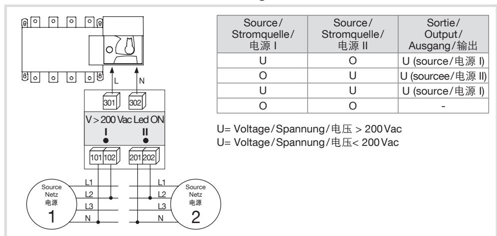
Exemple: commutateur motorisé + contrôleur + double alimentation/Example: motorised changeover switch + contrôleur + double power supply/Beispiel: Dual-Netzteil + Steuerungsgenät + Automatischer Motorumschalter/
