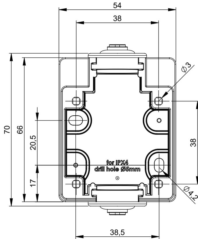
Ansicht ohne Flanschdichtung und Schrauben / view without flange gasket and screws
