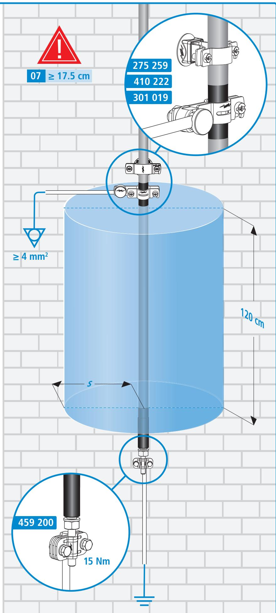
**DE** Stützrohr-Montage im Drei- oder Vierbeinstativ
