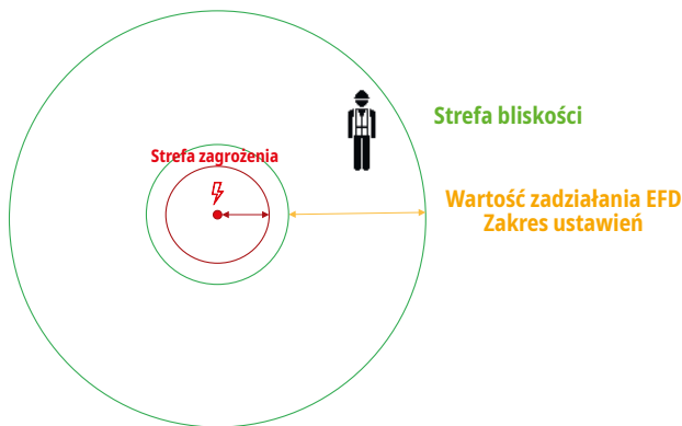
Rysunek 1 Strefa zagrożenia i strefa bliskości zgodnie z DIN VDE 0105-100
