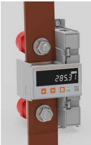
Rear mounting with insulators and 2 screws. Wiring: 1 bar. Montaż na izolatorach, 2 śruby. Okablowanie: 1 szyna.
