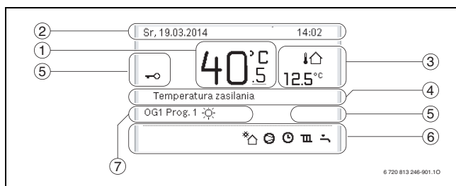
Rys. 4 Symbole na ekranie wskazania standardowego (przykładowy wyświetlacz)
