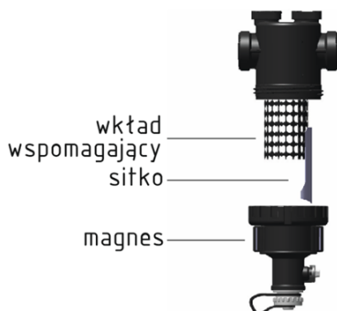
RYS. 10. BUDOWA FILTRA MAGNETYCZNEGO
