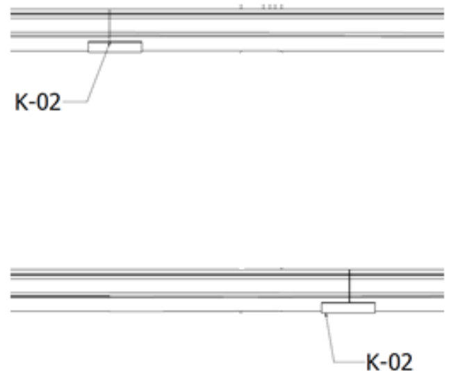
Poprawny montaż łączników K-02
