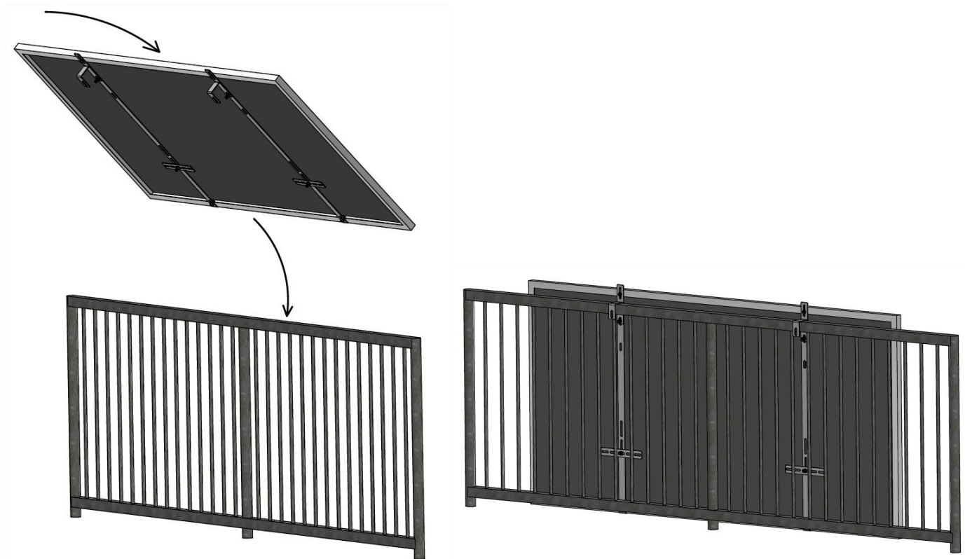
RYS.7 Montaż konstrukcji na balustradzie
