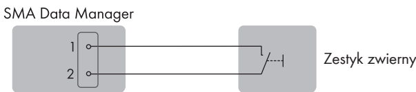
Ilustracja 8: Przykład podłączenia przełącznika szybkiego zatrzymania
