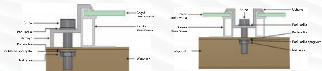
Rysunek 6 Instalacja modułów jednostronnych w uchwytych
