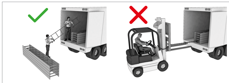
Rys. 1: Rozładunek tras kablowych
