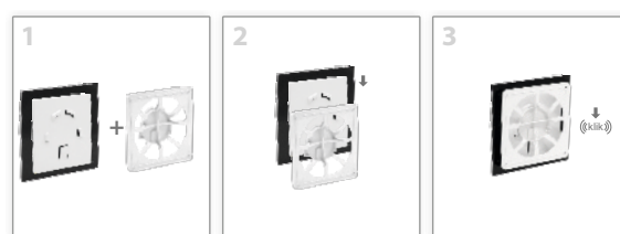
Montaż panelu na kratce (widok z tyłu) Panel installation on the grille (rear view) Montaje del panel en la rejilla (vista posterior)
