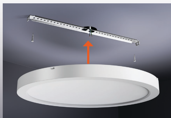
INSTALAÇÃO DE SUPERFÍCIE Para tetos sem recortes: remova as molas e monte a calha diretamente. Apenas para versões On/Off e com sensor.
