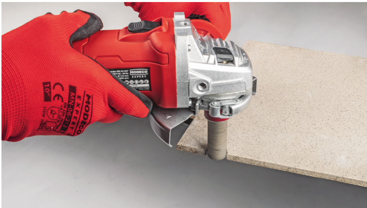
PRZYKŁADOWE ZASTOSOWANIE rozwiertaka cylindrycznego ze szlifówką kątową.
