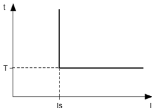
Rysunek 3.1 - Zasada działania zabezpieczenia zwłocznego niezależnego
