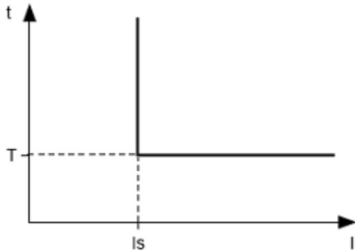
Rysunek 1.4. Zasada działania zabezpieczenia zwłocznego niezależnego
