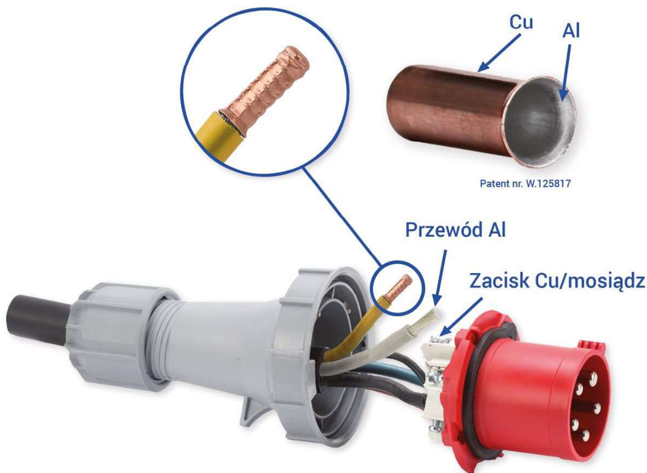
Zdj. 3 Przykładowe zastosowanie końcówek bimetalicznych HMA w przedłużaczach 3-fazowych
