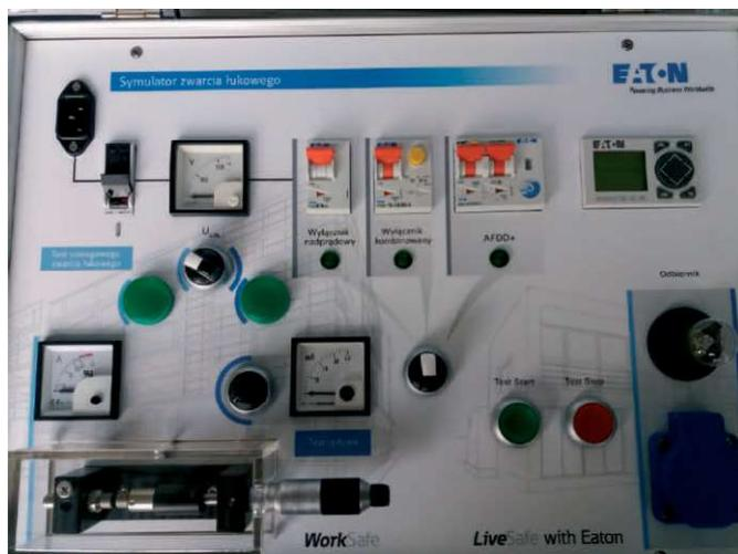
Rys.3 Przykładowa walizka testowa Eaton
