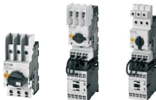
Zdjęcie 5: Eaton oferuje specjalne bloki zasilające zwiększające przestrzeń międzyfazową, aby zapewnić zgodność z wymaganiami rozruszników silnikowych UL typ E.
