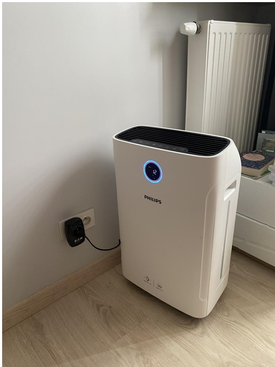
Rys.4 Oczyszczacz powietrza zabezpieczony ogranicznikiem przepięć typu box
